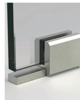
Le maintien de la paroi de verre est réalisé par deux pattes d'ancrage fixées sur une barre de seuil minimale collée sur le sol de façon invisible et étanche. Parfaitement solidaire du verre, un raidisseur est inséré dans un perçage ajusté du faux-plafond. Au mur, le pan de verre s'emboîte dans un profil très fin, quasiment dans le plan de la paroi, et simplement goupillé, absorbant les inégalités du mur pour réaliser l'étanchéité.
